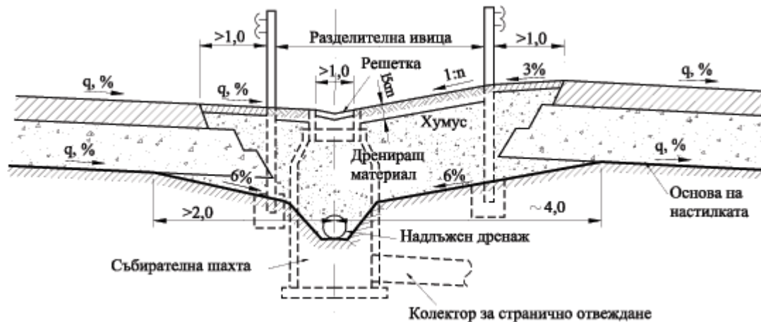
иг. 127. Отводняване на разделителната ивица на път в хоризонтална крива с R < 4500 m
