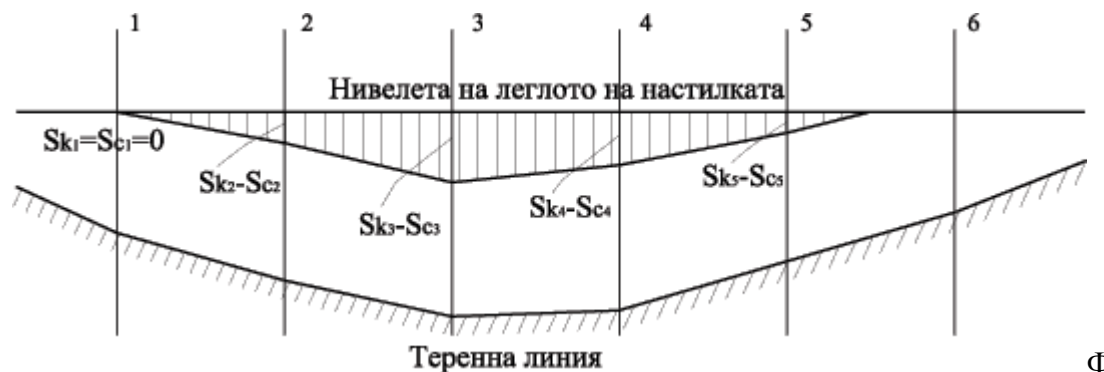
иг. 95. Надлъжна крива на слягането S_k , когато то се реализира в експлоатационния период на пътната конструкция
