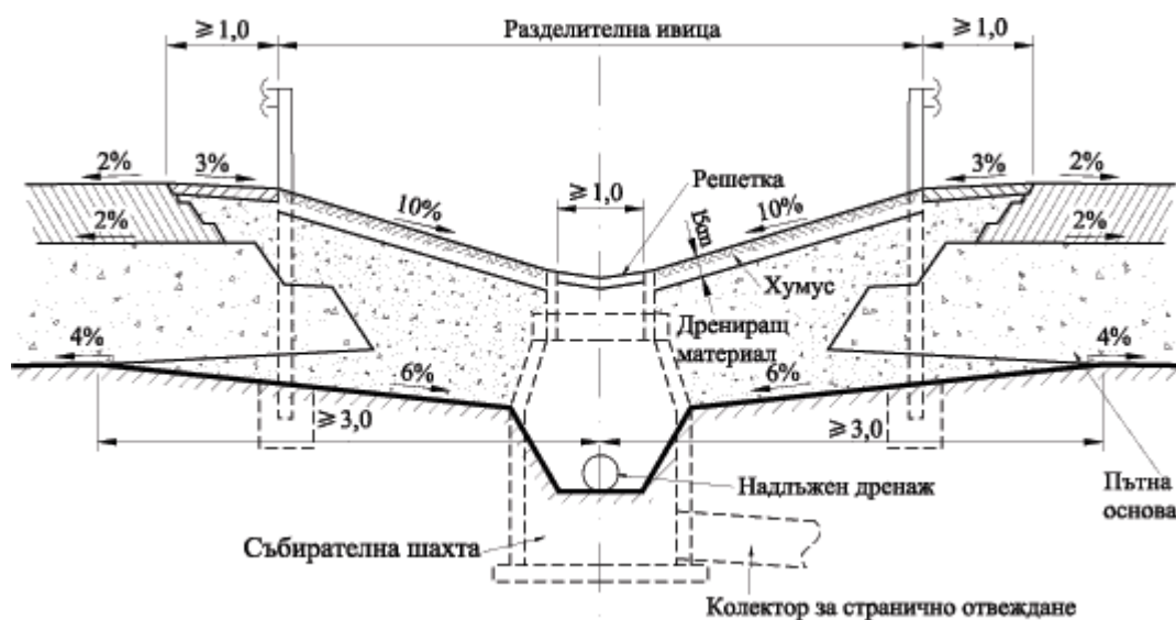
иг. 126. Отводняване на разделителната ивица на път в прав участък
