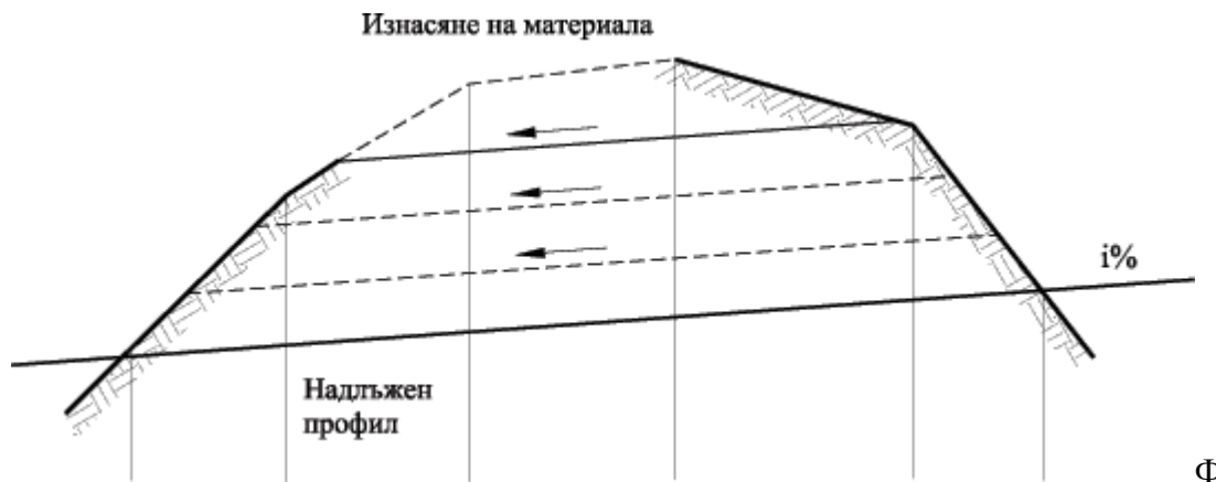
иг. 132. Отводняване на изкоп в надлъжно направление
