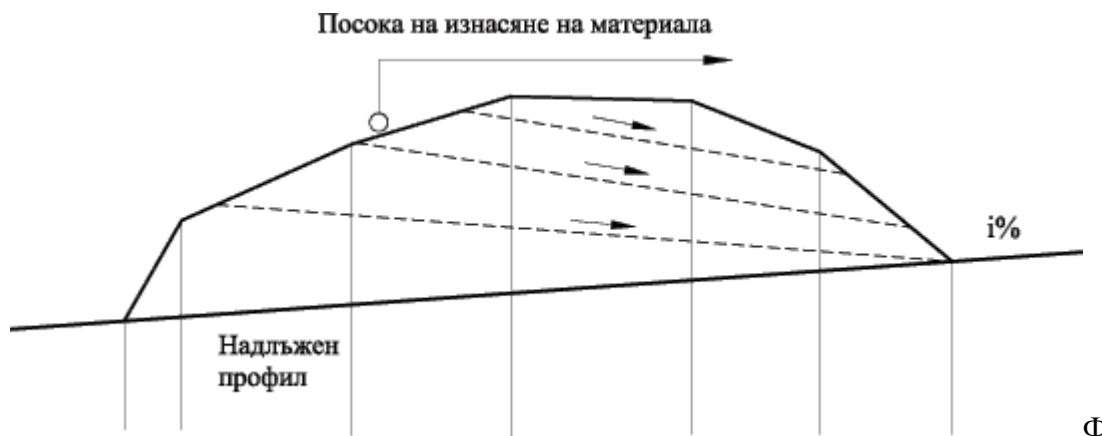
иг. 133. Отводняване на изкоп при изнасяне в посока, обратна на надлъжния наклон
