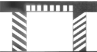
7. "Успоредни бели и черни линии, насочени към платното за движение" - M16. Обозначава пътни съоръжения - мостове, тунели, укрепителни и подпорни стени и други, разположени непосредствено до платното за движение;
